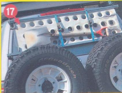
▲ Le support sur le hayon arrière permet de ranger les plaques à sable et la pelle, le tout reste ainsi immédiatement accessible.
